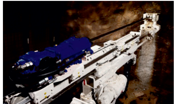
Telescopic drill feed with drifter HDP 15 Teleskopbohrlafette mit Bohrhammer HDP 15
